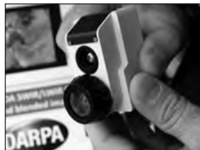
Η κάμερα τύπου PIXNET που παρουσιάστηκε στην επίδειξη της DARPA Demo Day. Παρουσιάζει μικρό όγκο και βάρος, ενώ δουλεύει ασύρματα.
